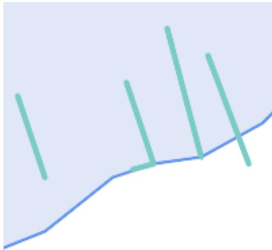
二つ目の例では、湖の境界とインタセクトし、かつ終端が岸に上がっている波止場を見つけます。言い換えると、波止場が湖に含まれるが完全には含まれず、湖の境界線とインタセクトして、波止場の終端が確実に湖内または境界にある場合を指します。空間述語を併用すると求める地物を見つけることができます。
