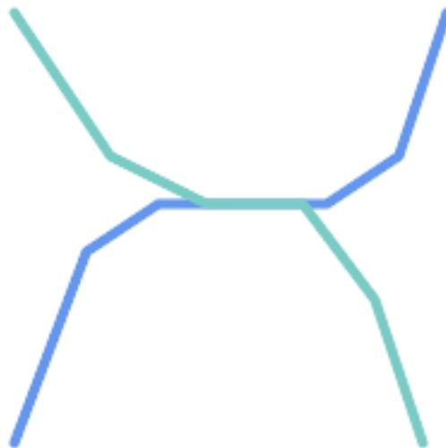
例えば、道路ネットワークを表現する線データセットを考えてみます。点でなく線で交差する全ての道路の辺を識別しなければならないことがあります (ビジネスルールの検証のためならありえます)。この場合、**ST\_Crosses**では、点で交差する場合しか **true** を返さないなので、必要な空間フィルタになりません。2ステップ解決法を示します。まず、空間的にインタセクトしている同路線の二本を抜き出し (**ST\_Intersects**)、実際にインタセクトしている部分を計算 (**ST\_Intersection**) します。次いで、インタセクトしている部分の**ST\_GeometryType**が **LINestring**かどうかを確認します (**[MULTI]POINT**、**[MULTI]LINestring**等の **GEOMETRYCOLLECTION** を返す場合に適切に処理します)。明らかに、より単純でより速い解法が望ましいです。
