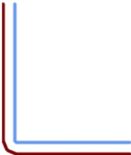
15, 'quad\_segs=4 join=bevel' と元のライン
