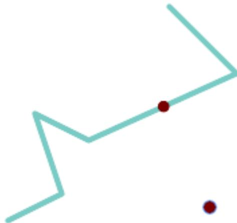
ポイントとラインストリングの最近傍ポイントは引数で与えたポイントそのものです。ラインストリングとポイントの最近傍ポイントはラインストリング上のポイントです。
