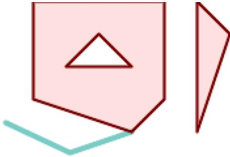
ラインストリングに 1.01 の許容距離でマルチポリゴンをスナップします。新しいマルチポリゴンはラインストリングにつながります。
