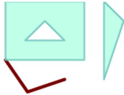
元のマルチポリゴンに **1.25** の許容距離でラインストリングをスナップします。新しいラインストリングはマルチポリゴンにつながります。
