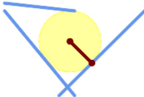
マルチラインストリングの最大の内接円。中心点、最近点と半径が返ります。
