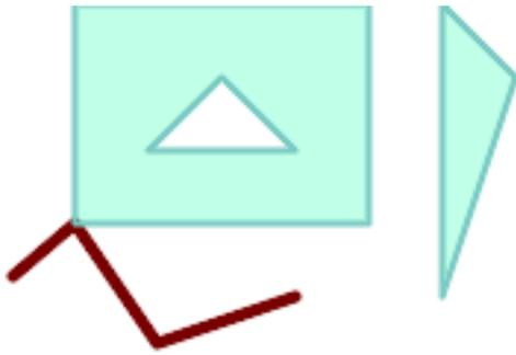
元のマルチポリゴンに **1.01** の許容距離でラインストリングをスナップします。新しいラインストリングはマルチポリゴンにつながります。
