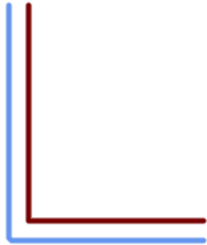
-15, 'quad_segs=4 join=round' ligne originale et son décalage de -15 unités
