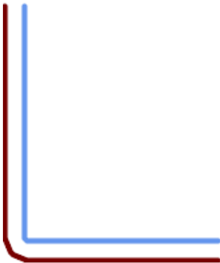
15, "quad_segs=4 join=bevel" montré avec la ligne originale
